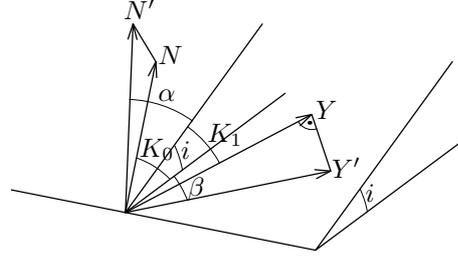
Azimut del eje  $Y$  de la fotografía:  $K_0 + \beta$ .
